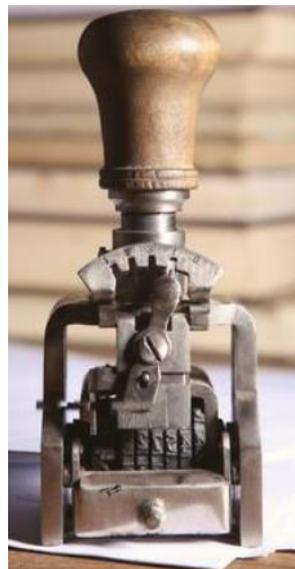
Muitas vezes, ao serem desmontados para limpeza ou conserto, a remontagem era feita errada o que ocasionava erros de impressão da data como por exemplo datas invertidas ou desalinhamento da datação em relação a LS e LI.
